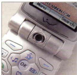
Kamera. A beépített digitális kamera 180 fokban elforgatható.
