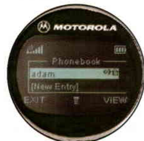
Negatív. A V70-es ún. inverse kijelzővel rendelkezik, melynek különlegessége, hogy sötét háttérrel jeleníti meg a világos karaktereket.
