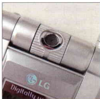
Kamera. A beépített digitális kamera 180 fokban elforgatható.
