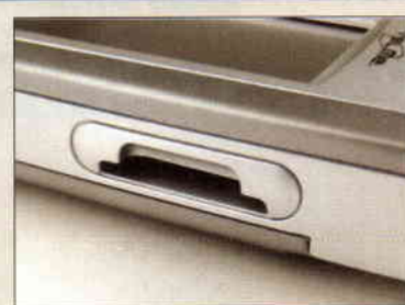
Memória. A memóriakapacitás növelését MMC kártyával oldhatjuk meg.
