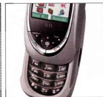
Szétcsúszás. Rendhagyó módon, a kijelző alól csúsztható ki az SL 55-ös billentyűzete.
